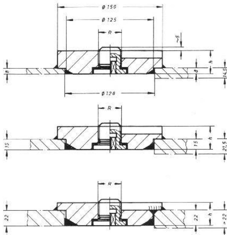
**Type 092265: mit Verschlusschraube aus Messing / with drain plug in brass**
